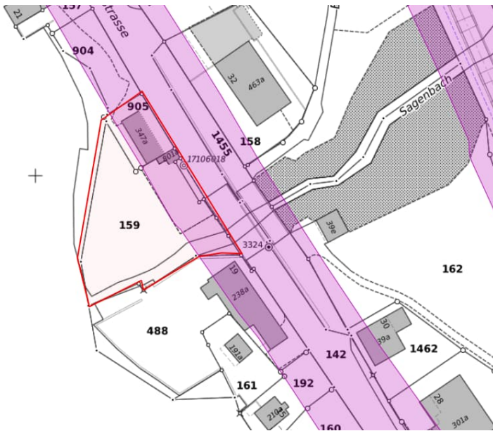
Abbildung 21: Prüferperimeter Bodenverschiebungen (PBV)
